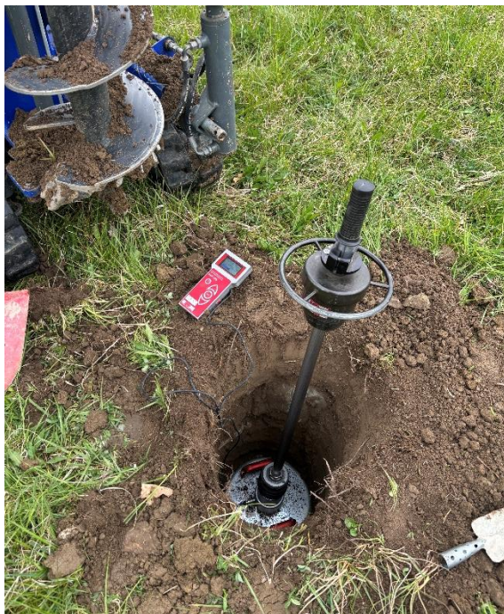
Slika 11: Sondažna vrtina SI 1 z Evd meritvijo
